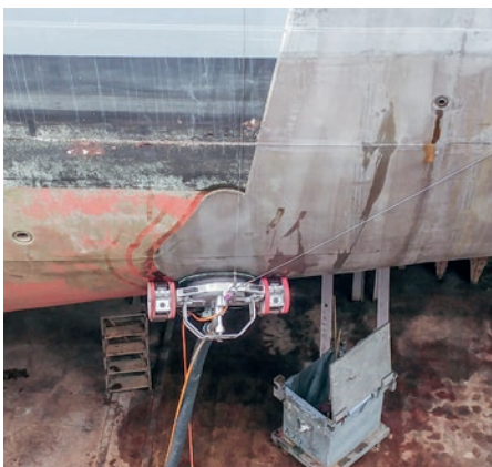
Der Spiderjet® V haftet durch Vakuum an der Arbeitsfläche mit gleichzeitiger Absaugung für Strahlwasser und abgetragene Feststoffe.
