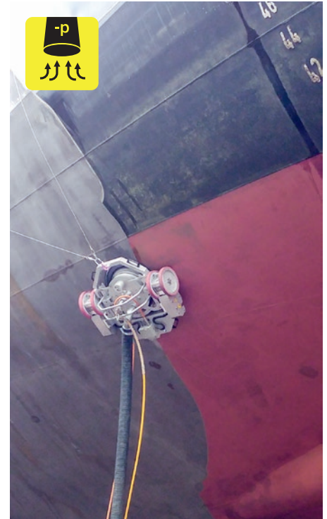
Der Spiderjet® V haftet durch Vakuum an der Arbeitsfläche mit gleichzeitiger Absaugung für Strahlwasser und abgetragene Feststoffe.
