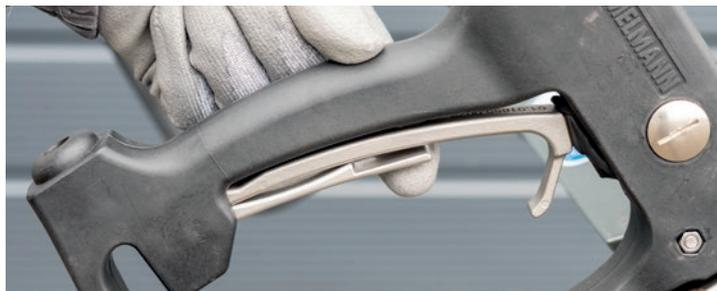
符合人体工程学的手动阀, 带有安全且易于操作的安全杆, 用于打开/关闭机械压力。
