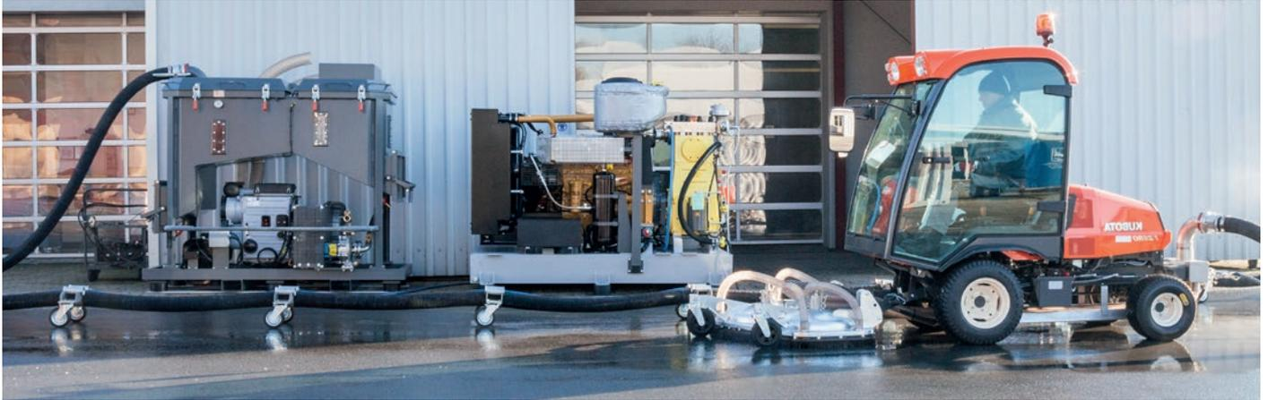
Système à vide pour l'aspiration et la pré-filtration de l'eau aspirée.
