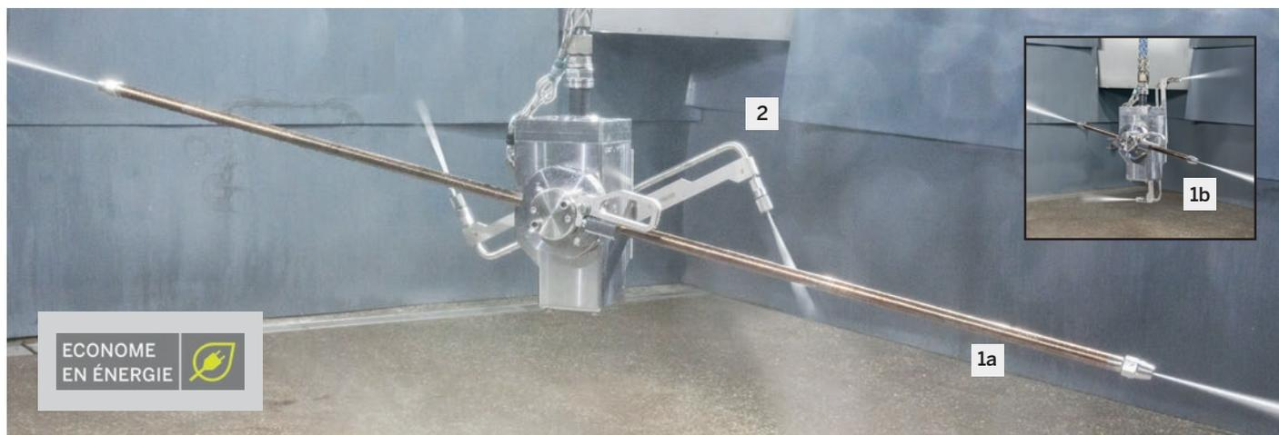
La durée du nettoyage est réduite par le mouvement d'oscillation des bras porte-buses. L'angle d'oscillation (A) peut être limité à 35 ou 83°. La rotation autour de l'axe vertical de l'appareil (B) peut être définie sur 36 ou 81°. L'appareil de nettoyage de réservoirs est positionné sur la paroi du grand réservoir (image 1), puis déplacé par sections.
