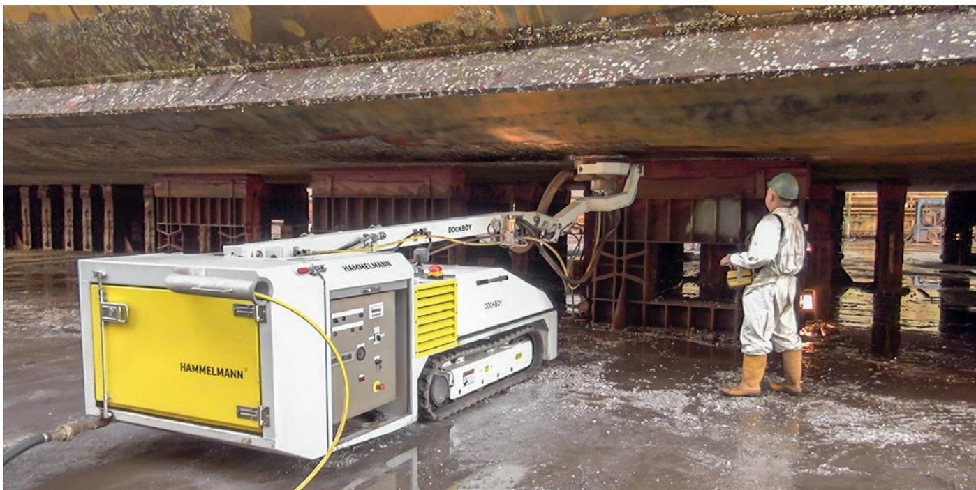
Le Dockboy est un système de nettoyage semi-automatique pour le traitement des coques de bateau et surfaces en acier similaires.
