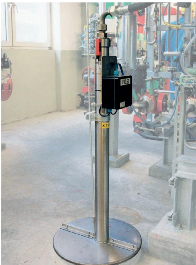
Système de lance, à déplacement hydraulique / pneumatique
