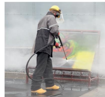
Pistolas pulverizadoras de agua caliente para trabajos de limpieza
