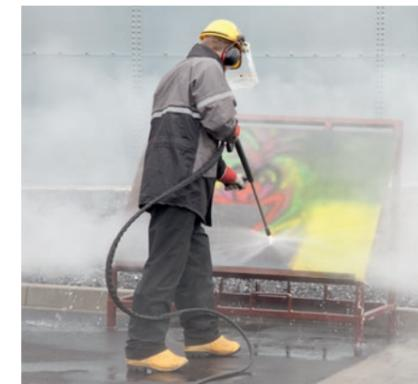
Heißwasserspritzpistole zur Reinigungsarbeit
